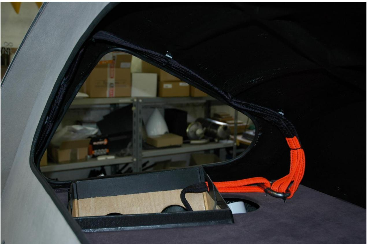
Die Ausschussöffnung der Rakete befindet sich auf der rechten Seite der Gepäckablage hinter den Sitzen. Das Rettungssystem ist von der Ablage durch ein Netz getrennt. Achten Sie bei der Beladung drauf, dass die Gepäckstücke das Rettungssystem oder die Ausschussöffnung der Rakete nicht blockieren.
